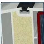
Weitere Verbesserung der Wärmedämmung durch den Einsatz der Schaumtechnologie IKD möglich
